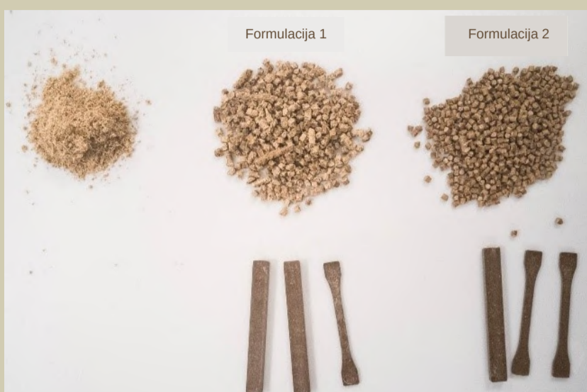
Različne formulacije biokompozitov na osnovi hmelja, pretvorjene v raztezne in upogibne eksperimente, s pomočjo katerih so določene mehanske lastnosti
