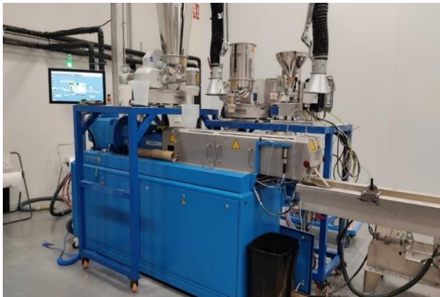
Máquina de extrusão (COPERION)
