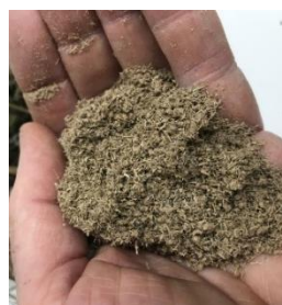
Fibras modificadas do desperdício de lúpulos
