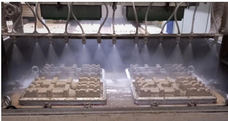
Výroba trayů z nasávané kartonáže
