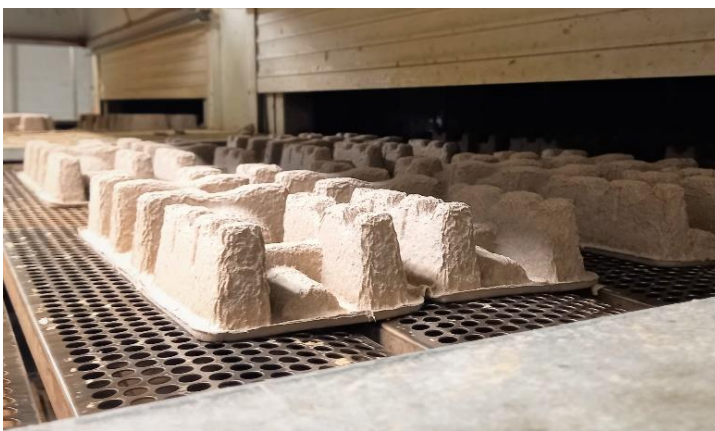
Traye na páse jdoucí do sušicího zařízení
