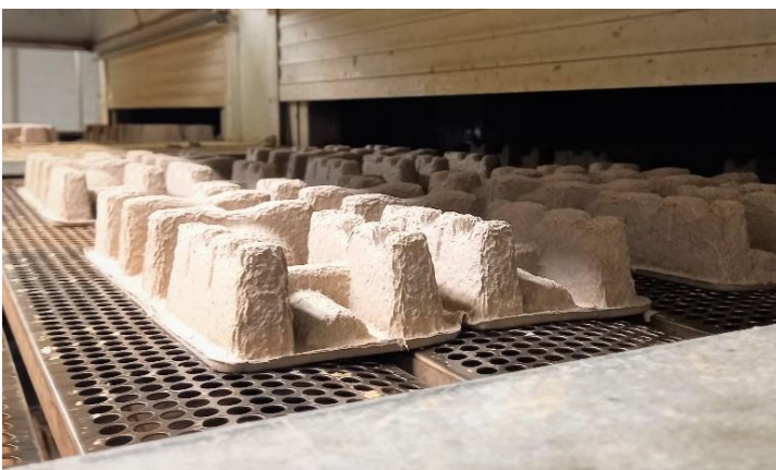
Nasse Schalen kommen zum Trocknen in den Ofen
