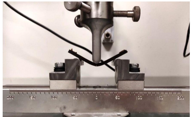
Mechanische Charakterisierung der BIOTHOP-Verbundwerkstoffe
