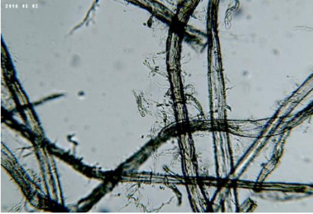
Defibrillierte/entwickelte Lignozellulosefaser nach dem Zelfo- Verfahren
