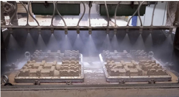
Formung der Schalen und Übergabe an das Band
