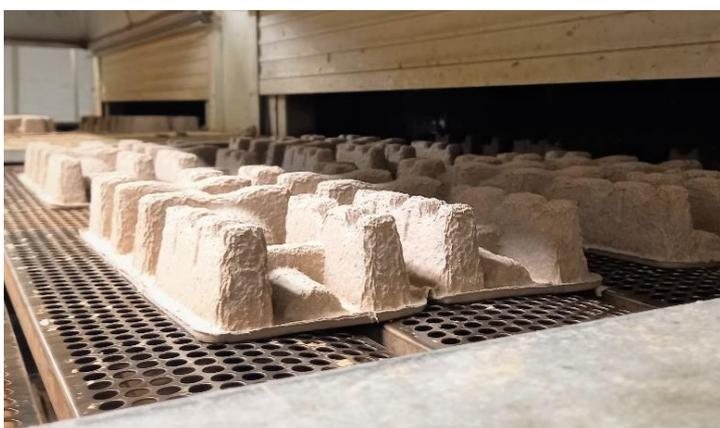
*Bandejas en proceso de secado*
