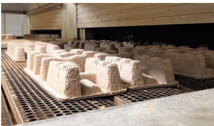
*Bandejas en proceso de secado*
