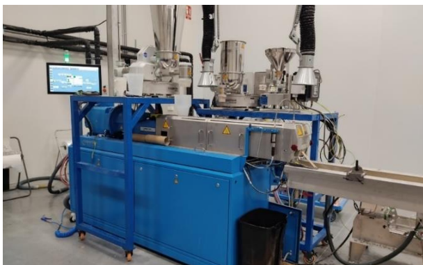
Dvopolžni ekstruder za pripravo kompozita (COPERION)
