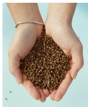
Bio-composite fabricado con restos de residuo de lúpulo
