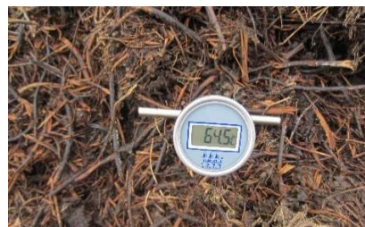
Vbodni termometer in prikazovalnik vbodnega termometra (Foto: L. Luskar)
